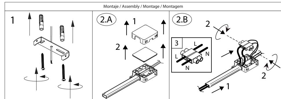
**Para asegurar la estanqueidad de la regleta de conexión y la seguridad eléctrica, es necesario conectar los cables de la manera siguiente:**
